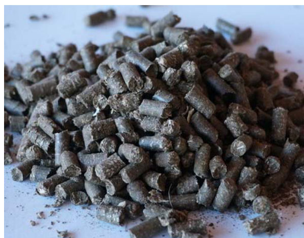
Figura 21. Pellets obtenidos con humedad inicial de materia prima de 20,2%
