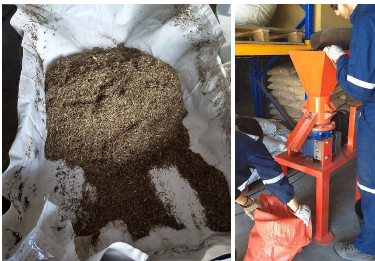
Figura 8. Pruebas de pelletizado de muestra de brea verde Huasco Bajo
