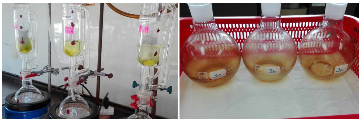
Figura 3. Sistema de extracción Soxhlet a nivel laboratorio y extractos obtenidos
