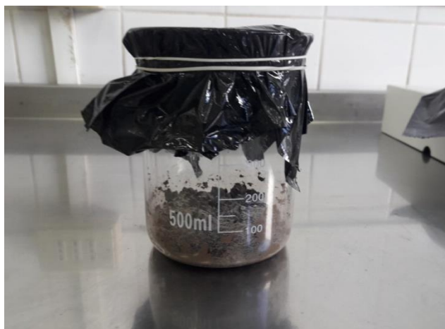
Figura 3. Prueba de sulfatación para el mineral de Planta Manuel Antonio Matta.
