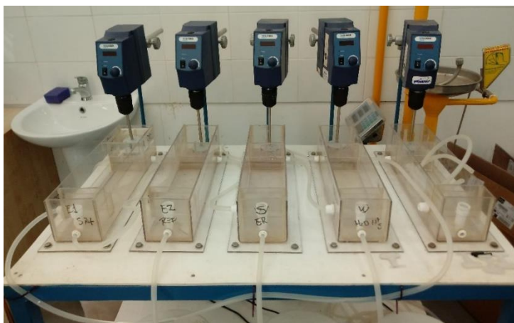
Figura 20. Planta piloto de extracción por solventes circuito 3E-S-W con conexiones de bombas y serie de agitadores
