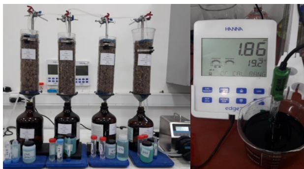
Figura 11. Montaje final de las pruebas de columnas de lixiviación.
