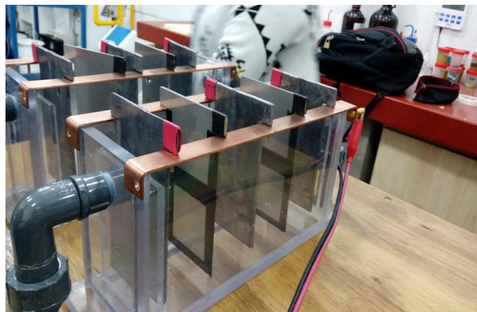
Figura 23. Electrodos instalados dentro de la celda electrolítica
