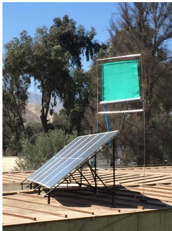
Figura 5.4: Fotografías de la unidad captadora modelo R , basada en la técnica tradicional con malla Raschel.
