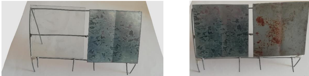
Figura 1.2: Láminas cuadradas de 10x10 cm de distintos materiales (vidrio, zinc, fierro y cobre) dispuestas en ángulo, modelo tipo captador de rocío.
