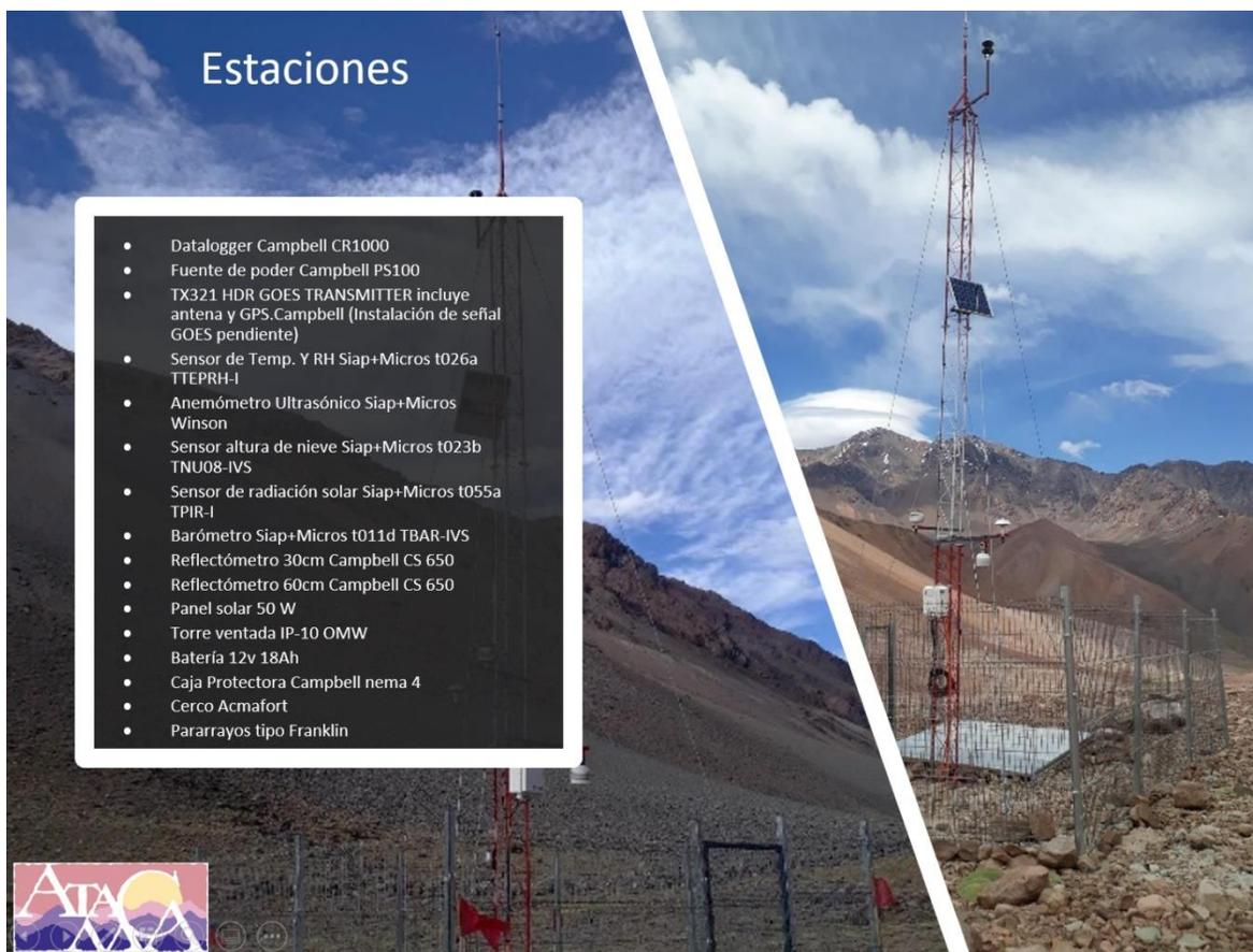
Figura 5 instalación de estaciones en Potrerillos y Barriales.
