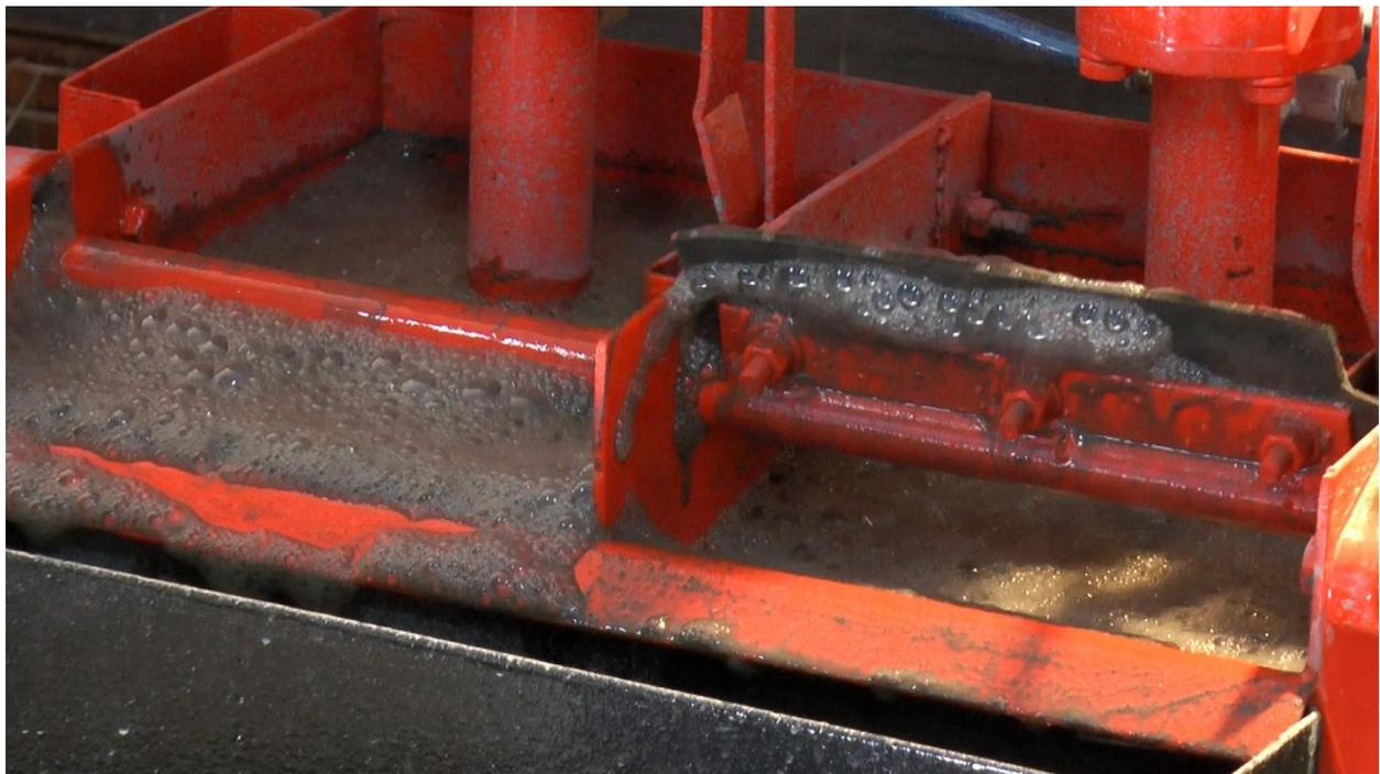
Figura 14. Celdas de flotación de la mini planta piloto.
