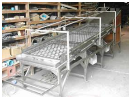
Figura 7: Máquina tamizadora de ostiones para el proceso de desdoble y cosecha del ostión.
