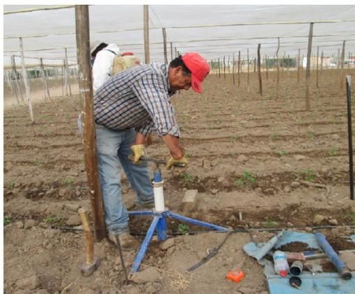
Figura 18. Instalación de sonda de capacitancia en cultivo de ají variedad Inferno, marzo 2014.
