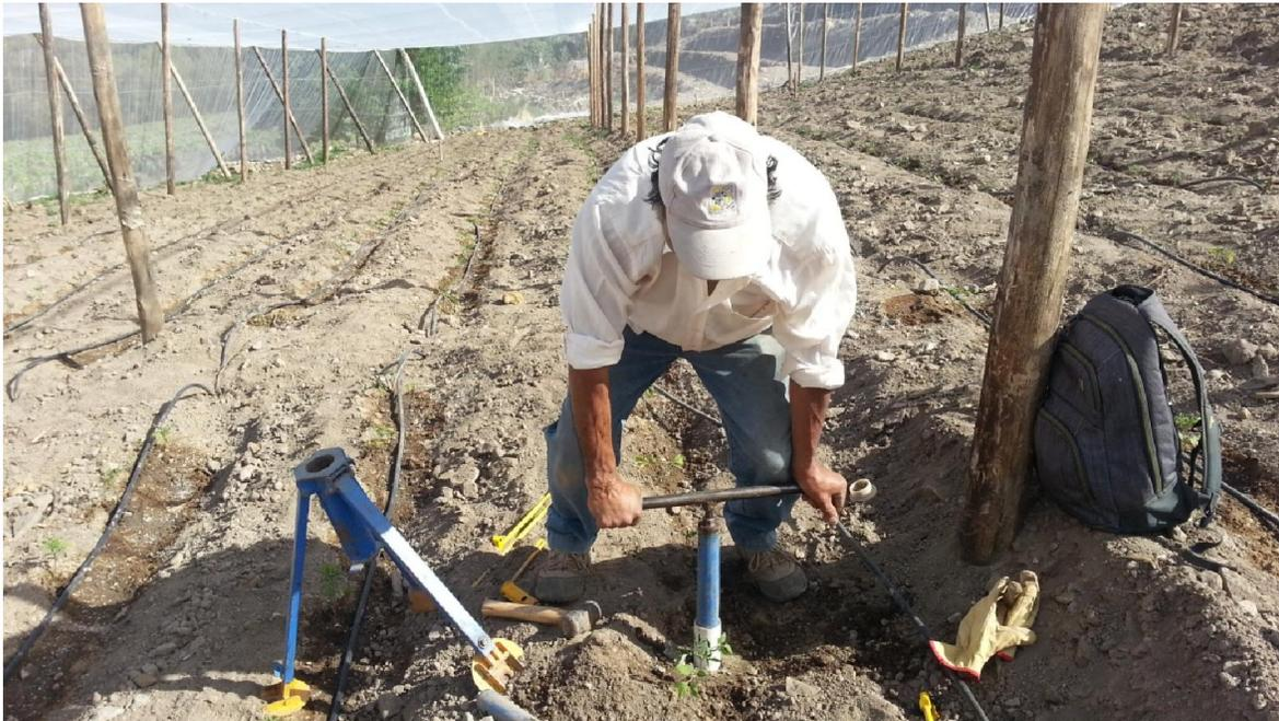
Figura 41. . Instalación de la sonda de capacitancia en el cultivo de tomate de Ángel Gómez, Alto del Carmen.
