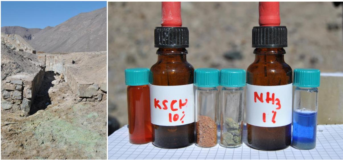
**Foto 23.** Sedimentos de coloración verde y rojiza en lavadero de Llanta (a la izquierda). Evidencia de altos grados de polución por hierro y cobre soluble, por reacción química que produce de color rojo y azul, respectivamente (a la derecha).
