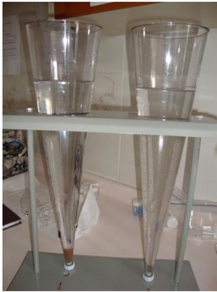
Imagen final del proceso de sedimentación y producción de lodos según el método normalizado de medida en conos Imhoff.
