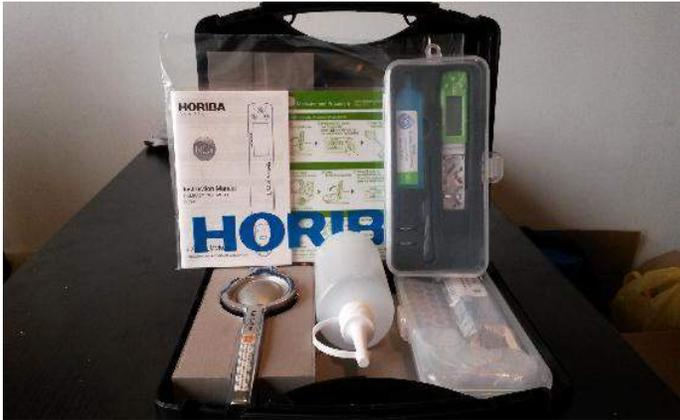
Figura 7. Medidor de nitratos ionómetro portátil Cardy Horiba®.
