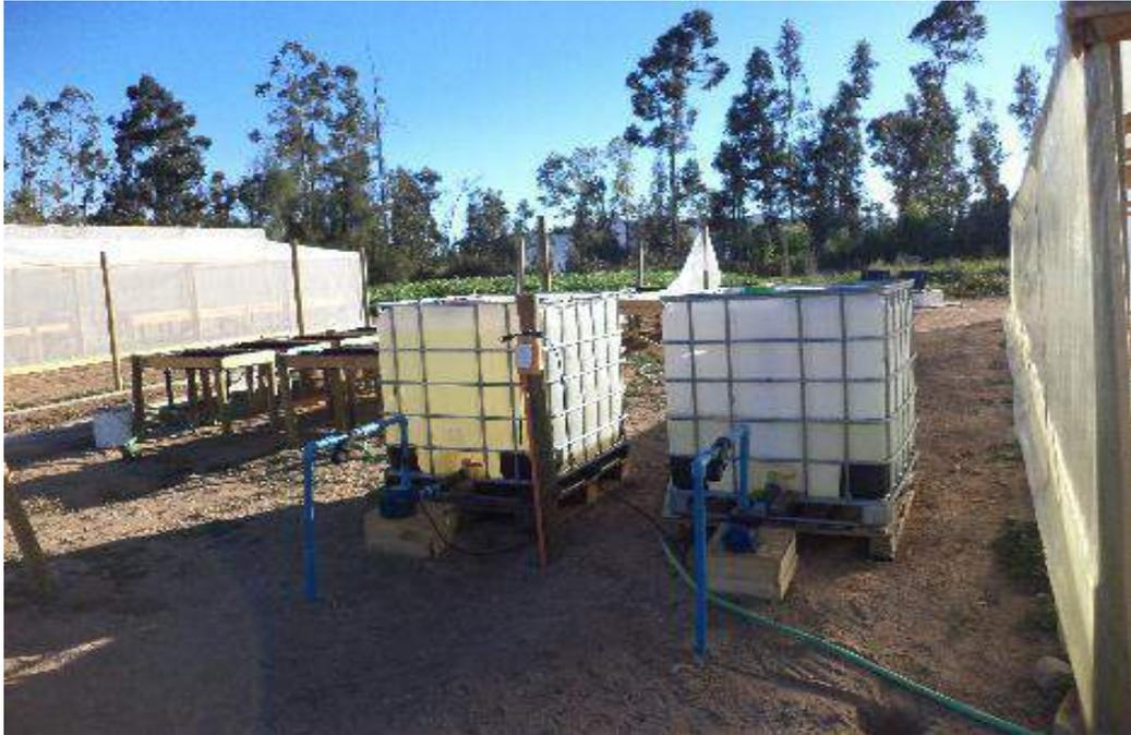
Figura 7. Estanques para solución nutricional requerida para cultivos de tomate y zapallo, con bombas centrífugas para el riego presurizado.
