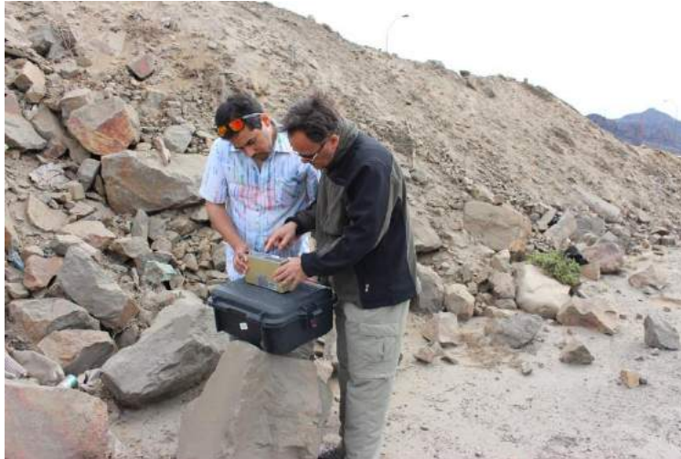
Figura 22. Monitoreo ambiental con equipo Espectrómetro Laser de Aerosoles, marca Grimm, en los alrededores de la empresa termoeléctrica Guacolda, Huasco.
