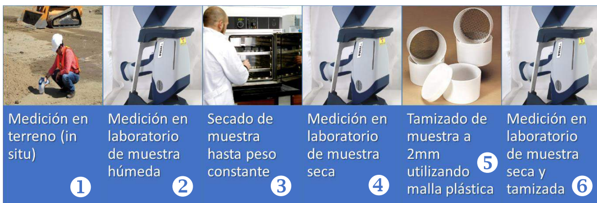
Figura 15. Esquema del tratamiento que recibieron las muestras de suelo para evaluar el efecto de la humedad y la granulometría en la determinación de elementos con equipo XRF portátil.
