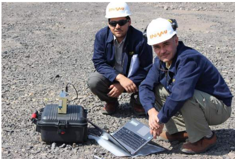
Figura 28. Monitoreo ambiental con equipo Espectrómetro Laser de Aerosoles, ENAMI, Paipote.
