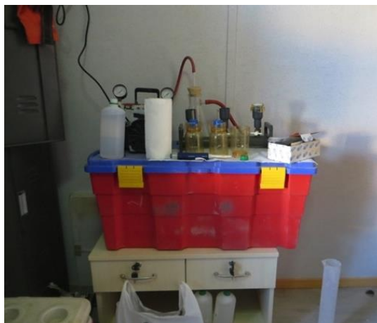
Figura IV.4. Sistema de bomba al vacío montado en campamento para filtración de agua.
