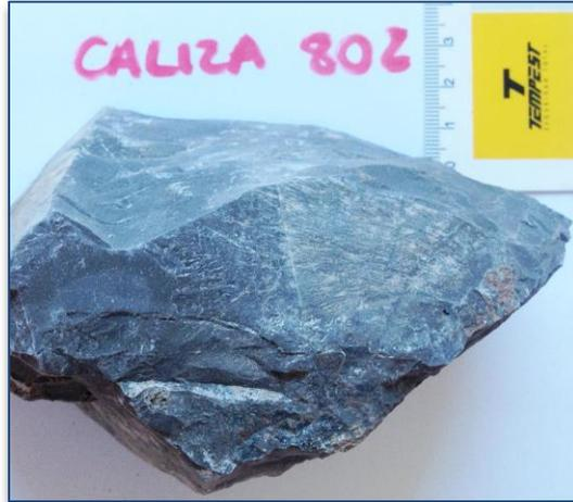
Figura 25. Foto de la muestra de caliza 60% CaCO<sub>3</sub>.
