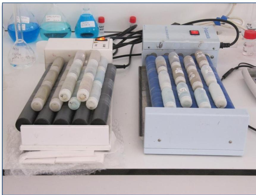
Figura 18. Foto de la fase de contacto entre el mineral y la solución contaminante.
