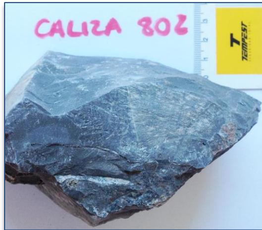
Figura 22. Foto de la muestra de caliza 80%  $\text{CaCO}_3$ .
