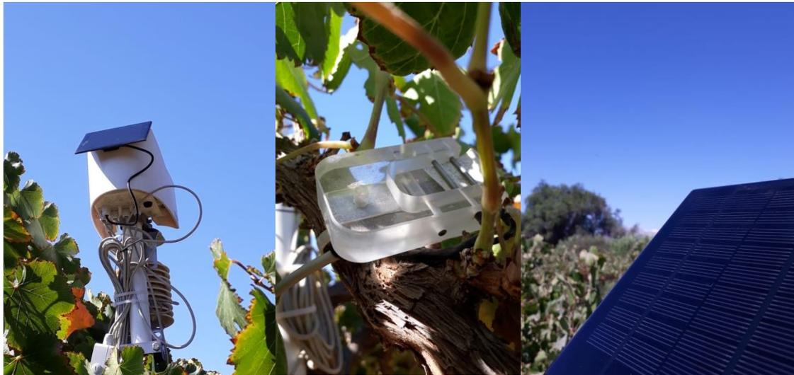
Cada una de las estaciones dispuestas en campo poseía un plan de datos que transmitían remotamente la información a través del software AgViewer permitiendo analizar en tiempo real las variables climáticas de forma individual o realizar comparaciones entre estaciones generando gráficos (Figura 19) y planillas Excel.
