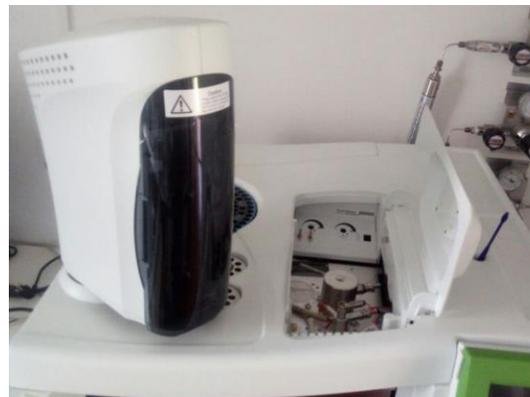
*Figura 10: Laboratorio de análisis de residuos de plaguicidas, cromatógrafo gaseoso con SD incorporado.*
