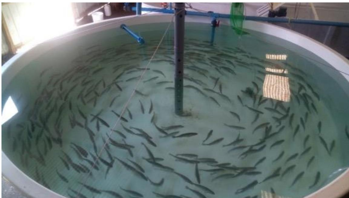
**Figura N°3: Estanque circular autolimpiante 12 metros cúbicos.**
