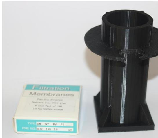
**Imagen N°5.** Celda de medición con membranas hidrófugas chinas.
