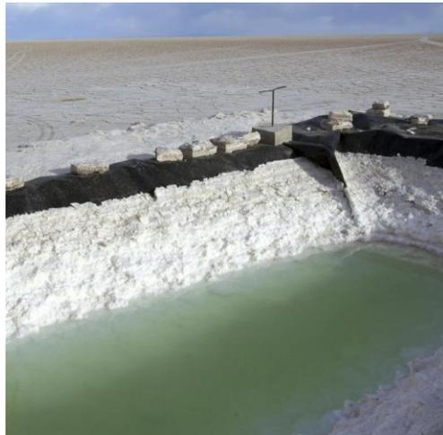
**Imagen N°1.** Balsa de evaporación de salmuera en la extracción tradicional de litio
