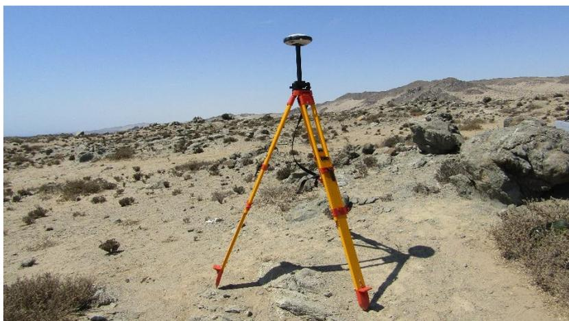
**Fig. 23.** GPS Spectra SP60 para levantamiento de puntos de control.
