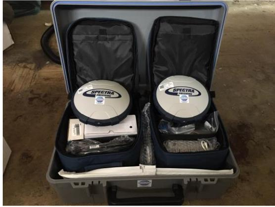
**Fig. 2.** Maleta con receptores SP60 L1/L2 GNSS y accesorios
