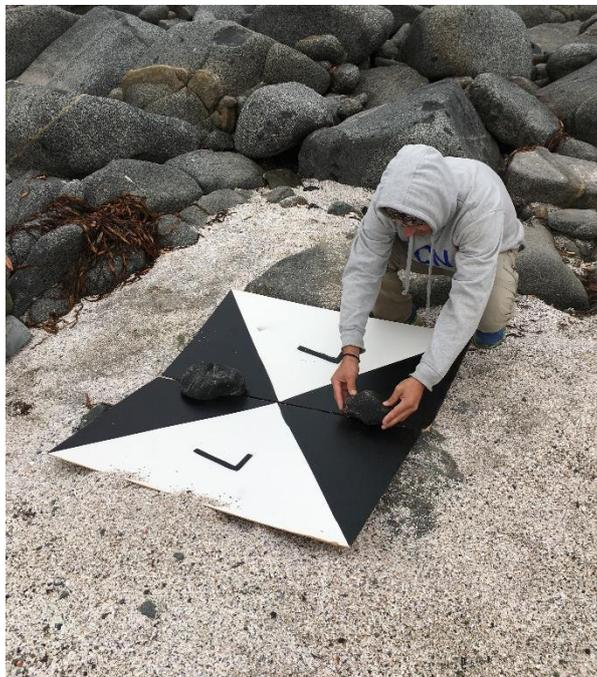
**Fig. 27.** Distribución de puntos de control para fotogrametría.
