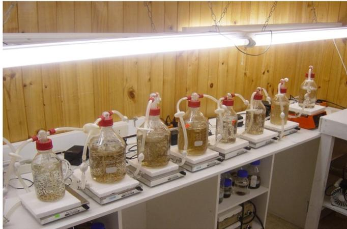
Fig. 8. Crecimiento de esporofitos iniciales de *M. integrifolia* -procedentes de Bahía Chasco- en cámaras de cultivo dentro de botellas de 1L sobre agitadores magnéticos
