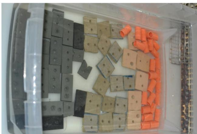
Fig. 5. Sustratos para la siembra de esporas. De izquierda a derecha: Cerámicas negras, cerámicas blancas y trozos de PVC
