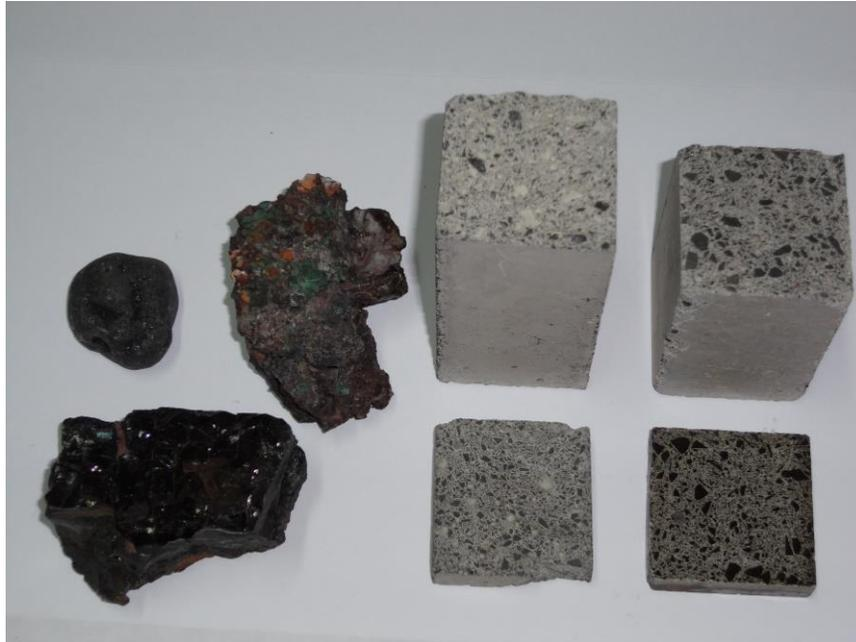
Fotografía N° 1. Muestras de escorias de diversa procedencia junto a morteros con superficies en bruto y pulida.
