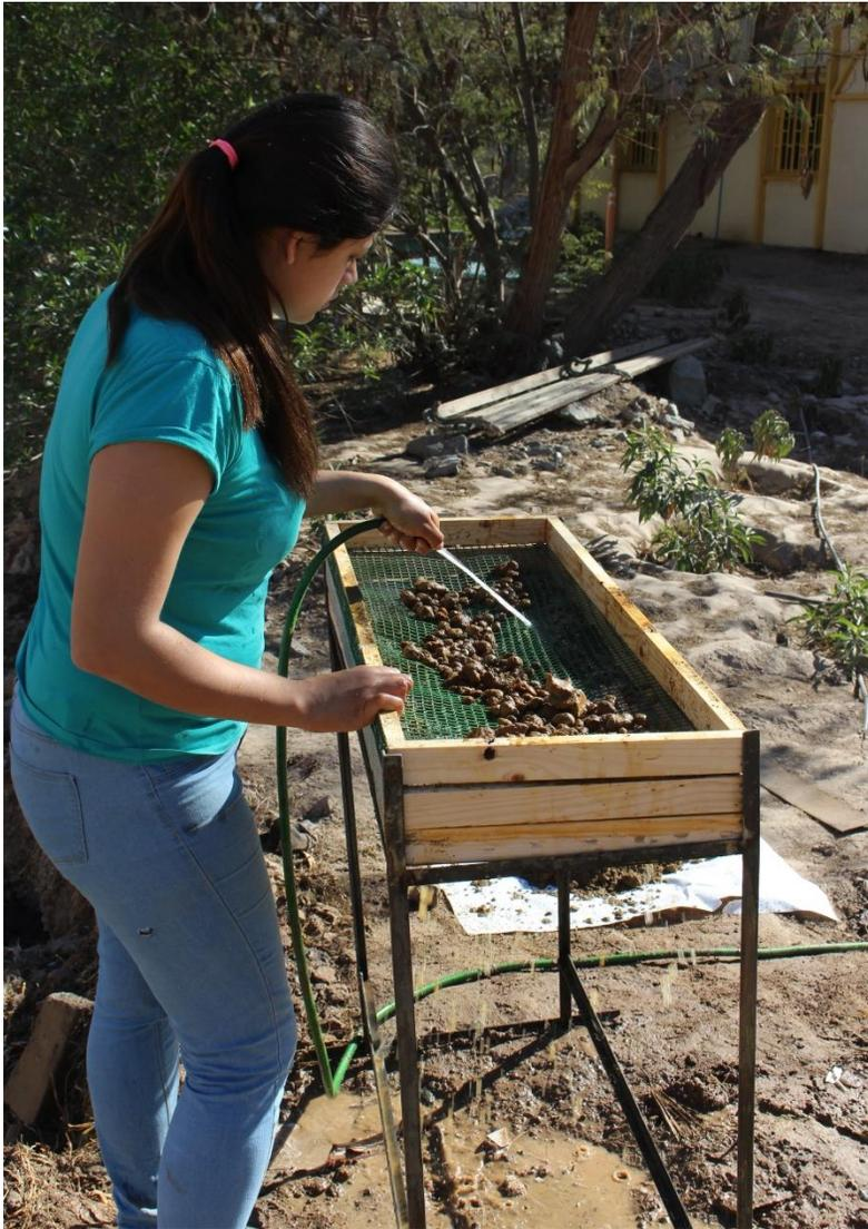
Figura 27.- Tamizado de los materiales en las instalaciones de la UDA.
