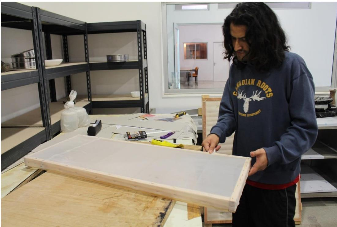
Figura 26.- Construcción de la mesa de tamizados.
