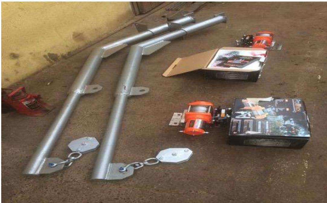
Figura 53.- Foto de los pescantes y winche de levante para la implementación de los botes para operaciones en los long-lines en mar.
