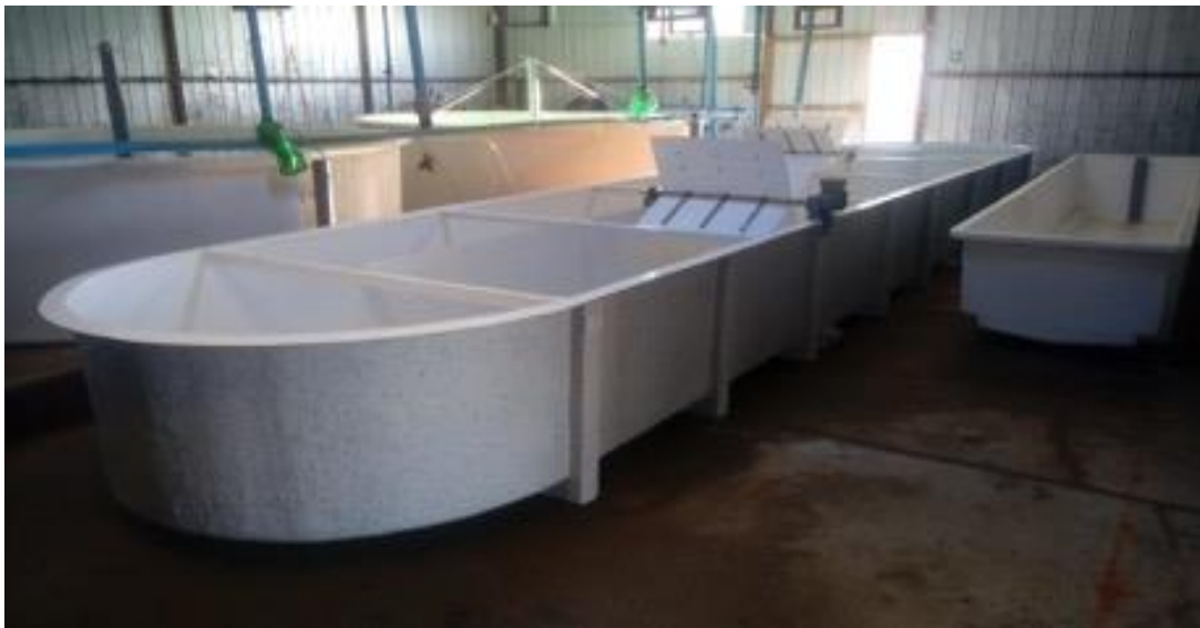
Figura 22. Estanque tipo hipódromo con 2 sistemas de impulsión mediante paletas.
