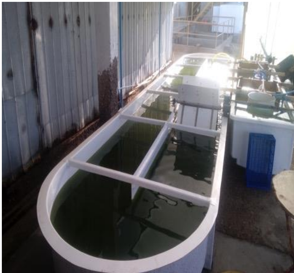
Figura 45. Cultivo masivo de la especie nannochloris sp. en estanque tipo hipódromo (batch 4). Fuente: Elaboración propia.
