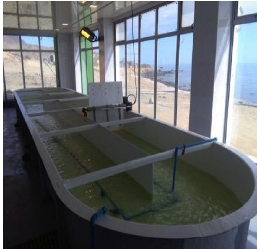
Figura 42. Estanque Hipódromo para cultivo de microalgas en fotobiorreactor del CIC-UDA. Fuente: elaboración propia.
