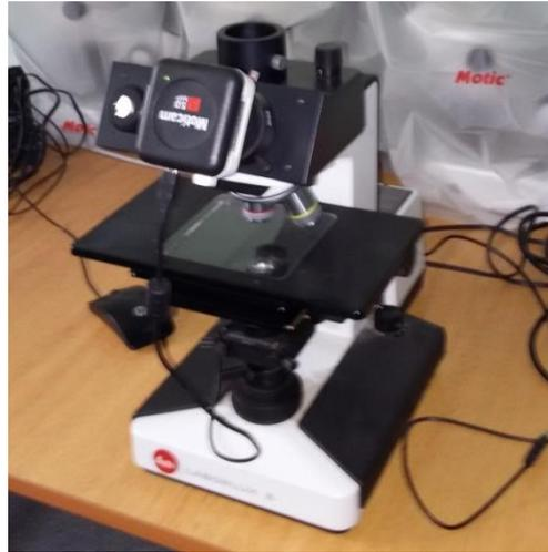
**Figura 2. Microscopio de luz transmitida para el estudio microscópico de muestras (Aporte de la Universidad de Atacama).**
