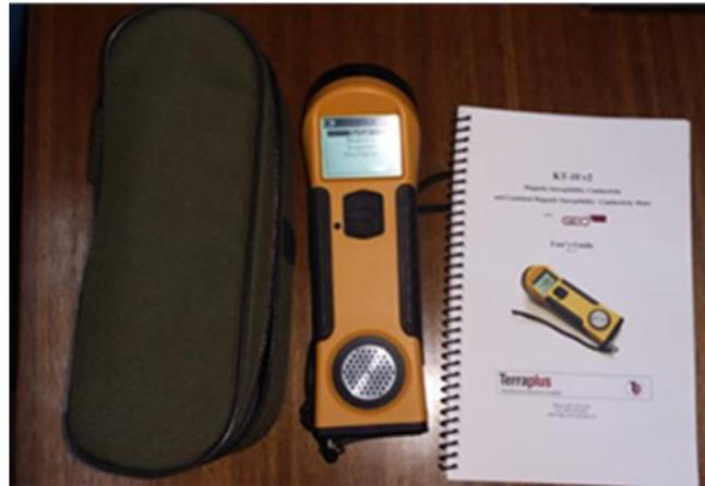
**Figura 4. Susceptibilímetro magnético modelo KT-10 marca Terraplus (Aporte del proyecto).**
