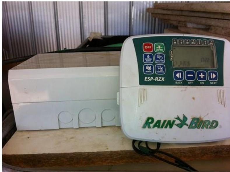
Ilustración 3. Programador que permite dar riegos automáticos cortos y frecuentes
