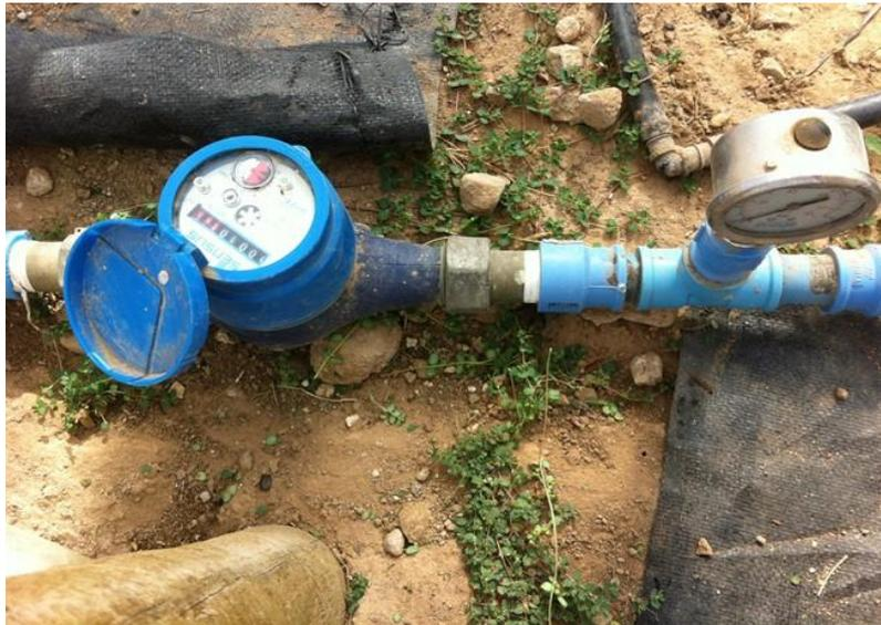
Ilustración 4. Caudalímetro para medir el agua efectivamente aplicada
