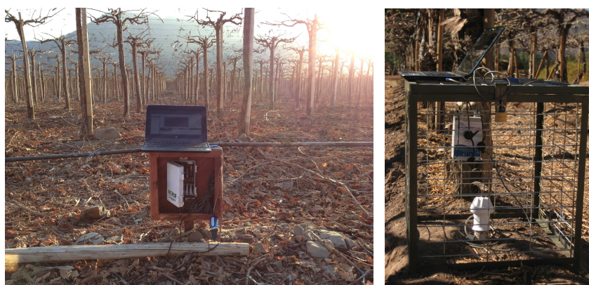
Figura 1. Equipos de seguimiento continuo del contenido de humedad y salinidad del suelo.
