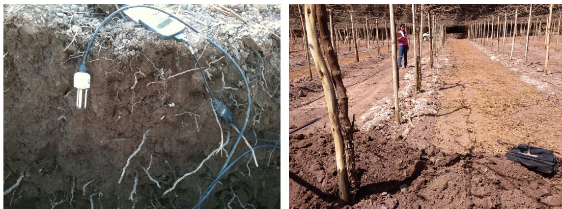
Figura 2. Equipos de seguimiento discontinuo del contenido de humedad y salinidad del suelo.
