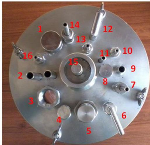
**Figura 16.** Accesorios del Reactor: 1: Toma de muestra; 2: intercambiado de calor tipo U, 3: Electrodo pH/OD, 4: conductor; 5 electrodo pH/OD, 6: toma de muestra, 7: descarga, 8: conductor, 9: termómetro, 10: dosificación sustancia, 11: dosificación sustancia, 12: salida de aire, 13: dosificación sustancia, 14: entrada de aire, 15: agitador, 16 dosificación sustancia
