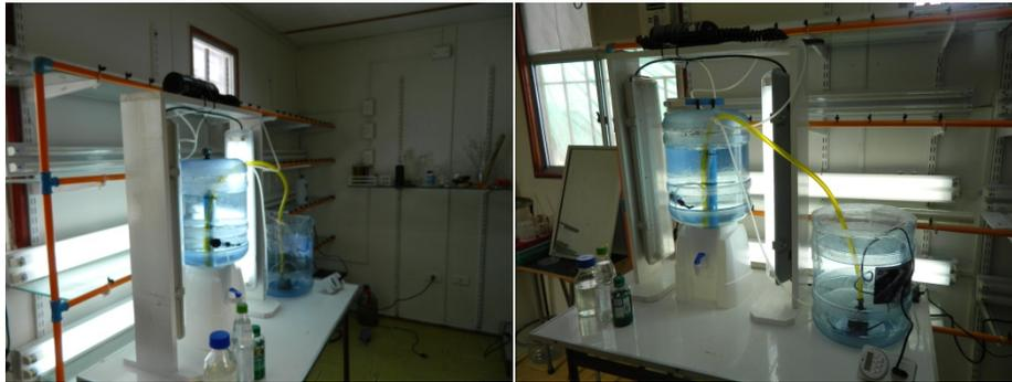
Fig. 34. Unidad de producción Continua de microalgas, instalada en el Liceo Manuel Blanco Encalada de Caldera, III Región
