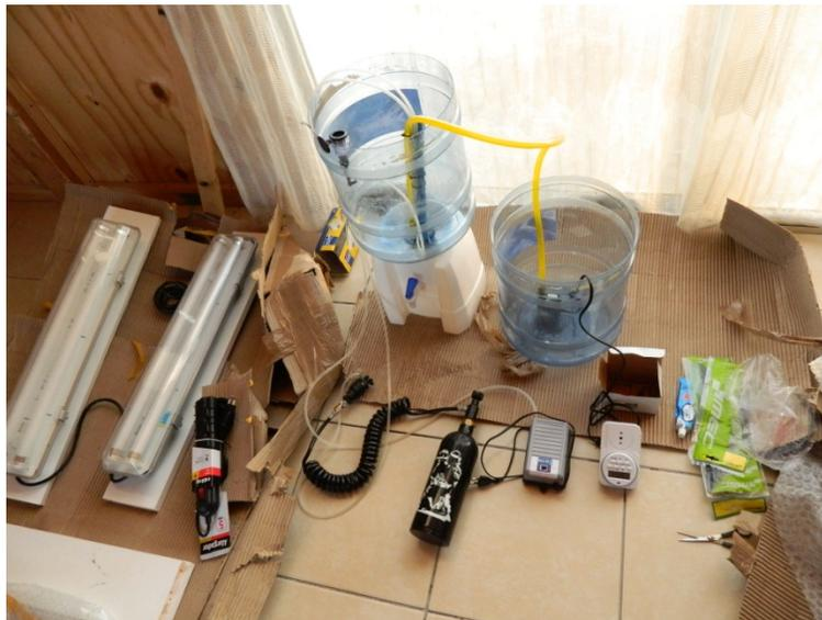
Fig. 31. Materiales utilizados en el sistema continuo de producción de microalgas
