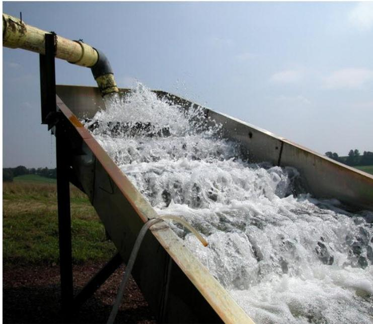
**Figura 7.** Cascada de aireación por gravedad en un ángulo de 25°.
