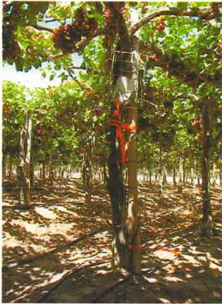
Figura 58. Datalogger instalado en T2 junto con los sensores en el parron de Red Globe.
