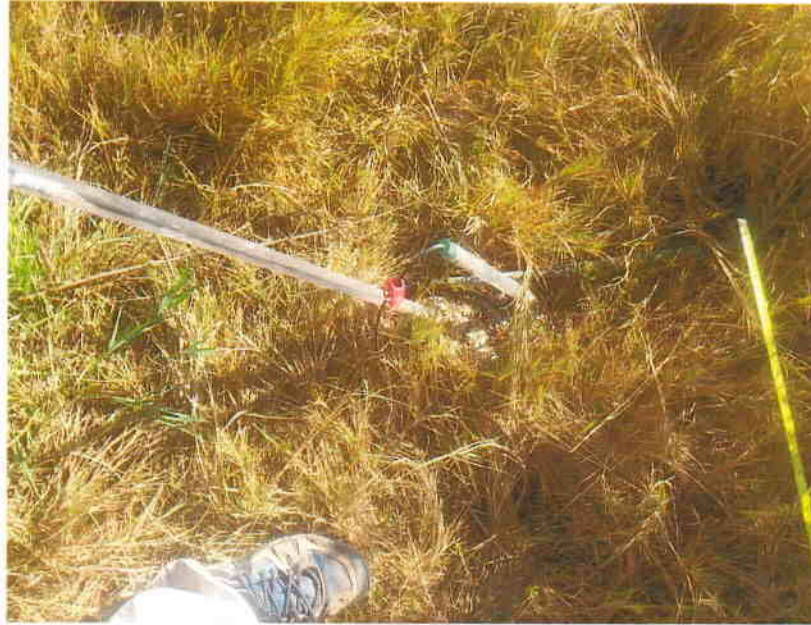
Figura 47. Se observan los lisímetros bajo un gotero en el tratamiento 0
