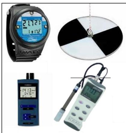
Foto.1. Equipos utilizados en este estudio para la cuantificación de variables fisicoquímicas de la columna de agua. a) Temperatura, b) transparencia del agua, c) salinidad y d) potencial de hidrogeno (pH).
